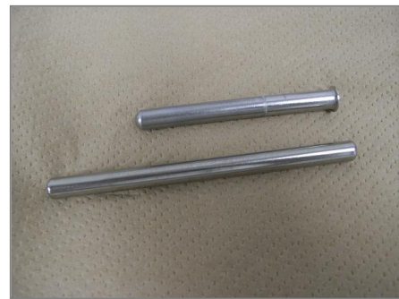
写真2 早期離乳ラット飼育用 給水筒長尺吸い口 (下)
